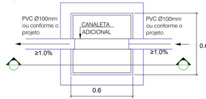
**DET. CAIXA DE INSPEÇÃO ESGOTO SIMPLES**
