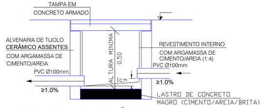
**CORTE DE CAIXA DE INSPEÇÃO ESGOTO SIMPLES**
